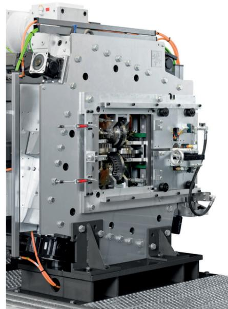
Das besondere Merkmal der Profilwalzmaschine WST im Vergleich zu den Typen WSN und WN ist die zusätzliche Einstellbarkeit der Walzen in axialer Richtung. Jede Walze ist somit radial und axial einstellbar.
