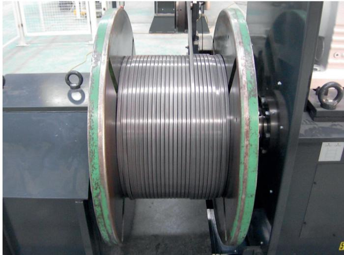
Die Maschinen des Typs SMH-Pi zeichnen sich dadurch aus, dass die Spulkörper von beiden Seiten aufgenommen werden. Dazu sind diese Maschinen mit einer Gegenpinole ausgerüstet.
