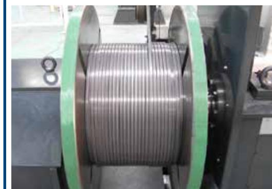
FUHR liefert ein breites Sortiment von Abwicklern. Die Maschinen unterscheiden sich in der Aufmachung sowie in der Größe bzw. dem Gewicht der zu verarbeitenden Gebinde. Abwickler liefert FUHR sowohl als Einzelaggregate zur Integration in bestehende Anlagen als auch im Rahmen von Komplettanlagen.
