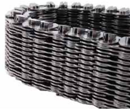
Die Aufgabe der CVT-Kette (Continuously Variable Transmission) in einem CVT-Automatikgetriebe ist die Leistungsübertragung von einem Kegelscheibenpaar auf das andere. Die Kette besteht aus mehreren Gliedern, die mittels Wiegegelenken beweglich miteinander verbunden werden. Diese vergleichsweise einfache, bis ins Detail hinein optimierte Konstruktion ist der Schlüssel für die besondere Stärke der Kette in Drehmomentkapazität und Wirkungsgrad.
