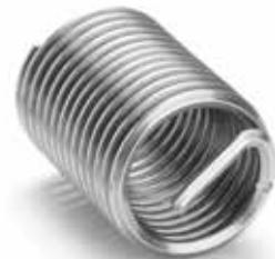
Gewindeeinsätze wurden ursprünglich zur Reparatur beschädigter Gewindebohrungen entwickelt. Heutzutage haben sie sich zur Verstärkung von Gewindebohrungen durchgesetzt, um z. B. hochbelastete Schraubverbindungen in Leichtmetallen zu ermöglichen. Ein Beispiel im Automobilbau ist die Verschraubung von Zylinderköpfen in Aluminiummotorblöcken. Im Flugzeugbau werden Zehntausende Gewindeeinsätze pro Flugzeug eingesetzt.
