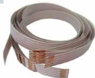
Das Flachbandkabel ist ein mehradriges Kabel, in dem die Adern nicht kreisförmig gebündelt in einem runden Isolierschlauch, sondern parallel nebeneinander angeordnet sind. Es wird vorrangig zum Verbinden von vielpoligen Signalleitungen in elektronischen Baugruppen und Computern verwendet. Auch in der Automobilindustrie gibt es Anwendungen, z. B. die Airbag-Leitung im Lenkrad.
