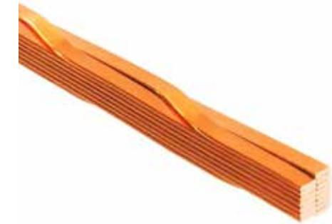
In den Wicklungen von elektrischen Motoren, Generatoren und Transformatoren werden zur Steigerung des Gesamtwirkungsgrades heutzutage zunehmend Kupferdrähte mit rechteckigem statt rundem Querschnitt eingesetzt. Die Wicklungen bestehen aus einer Vielzahl einzelner Drähte, die gegeneinander elektrisch isoliert sein müssen. Wichtig für die Qualität der Wicklung ist auch, dass die Einzeldrähte möglichst gleiche Längen aufweisen.
