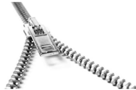
Jeder Streifen hat feine Metallzähne, aus Messing, Neusilber oder Aluminium, die beim Schließen durch einen Schieber ineinandergehakt werden. Von den zwei Wendeln (oder Helices) eines Reißverschlusses ist eine rechts- und eine linksgewendelt, damit sie gut zusammenpassen. Ebenso sind die Helixsteigungen im Überlappungsbereich reduziert und dafür dort, wo sie in das Textilband eingewebt sind, erhöht.
