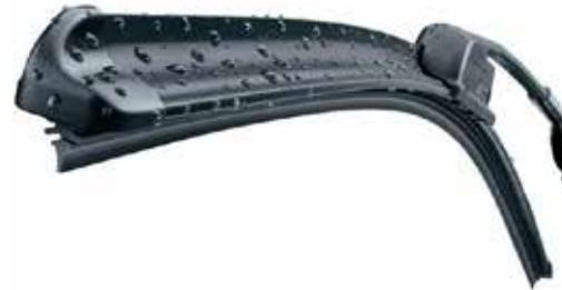
Konventionelle Scheibenwischer bestehen aus einem Wischerarm aus Metall, der an der Wischerachse angebracht ist. Ein Gelenk ermöglicht es, den Scheibenwischer von der Scheibe hochzuklappen. Für die ebenen Scheiben der Automobile früherer Generationen genügte als Wischerblatt eine starre Metallschiene, in die ein Gummiprofil eingeklemmt war.
