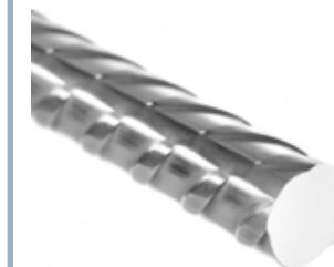
Eine wichtige Eigenschaft des Betonstahls ist dessen Verbund mit dem ihn umgebenden Beton. Zur Verbesserung des Verbunds werden Rippen aufgerollt oder aufgewalzt. Die Rippen haben eine maximale Höhe von 4,5 % und einen Abstand von 60 % des Stabdurchmessers. Durch die Rippen wird eine lokale Verzahnung zwischen Beton und Stahl erreicht, was eine optimale Kraftübertragung über eine kurze Verbundlänge ermöglicht.
