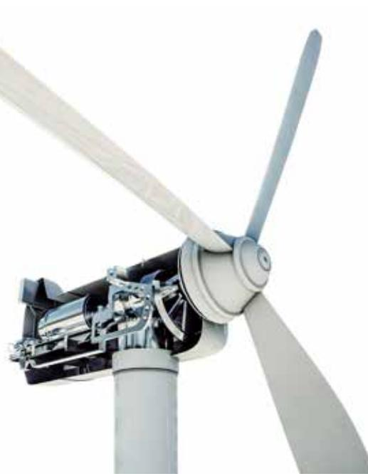
Eine Windkraftanlage besteht im Wesentlichen aus einem Rotor mit Nabe und Rotorblättern sowie einer Maschinengondel, die den Generator und häufig ein Getriebe beherbergt. Es gibt auch getriebelose Anlagen. Die Gondel ist drehbar auf einem Turm gelagert, dessen Fundament die notwendige Stand-sicherheit gibt. Dazu kommen die Überwachungs-, Regel- und Steuerungssysteme sowie die Netz-anchluss-technik.
